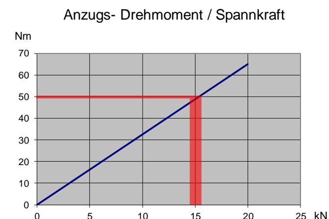
Beanspruchungen über dem max. Anzugsmoment führen zu Schäden an der Spindel.
