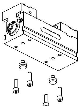
In der Grundausführung sind 2 x Ø8 H7 Positionierbohrungen vorhanden, mit denen der KSO auf Rasterplatten mit 50er Teilung, sowie in T-Nut Tischen positioniert werden kann. Der KSO wird mit 4 Zyl.-Schrauben M8 von unten befestigt.
