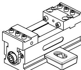
Alternativ kann der KSO auch mit Spannpratzen aufgespannt werden.
